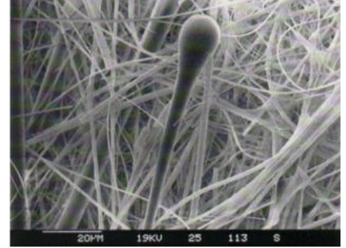
HEPA Filtrenin İç Yapısı
